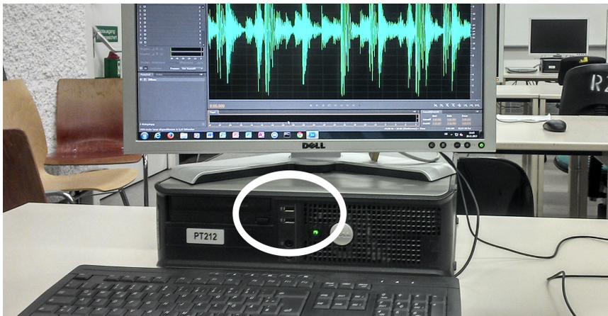
USB-Anschluss an CIP-Pool-Rechner
