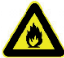
Warnzeichen W 1 Warnung vor feuergefährlichen Stoffen
