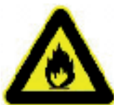
Warnzeichen W 1 (Warnung vor feuergefährlichen Stoffen)
