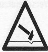
Scharfe Felskanten, Steinschlag oder ein Treffer mit dem Eisgerät können dem Seil lokal eine tödliche Wunde zufügen. Wird der Mantel so verletzt, dass der Kern sichtbar ist, oder sind gar Fasern des Kerns mit durchtrennt, sollte man das Seil aussondern. Besonders bei Einfachseilen, wo kein zweiter Strang  $\rightarrow$  Redundanz verspricht, sollte man vorsichtig sein.
