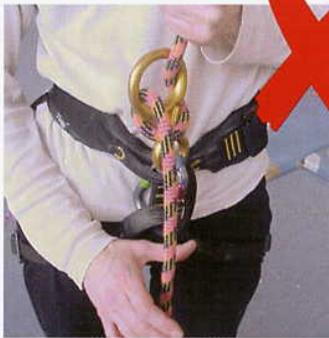
← Bremsseil wird beim Sichern losgelassen, um nachzugreifen.
