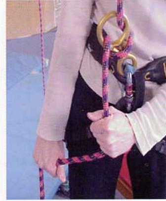
d) Falsche Zugrichtung beim Halten des Bremsseils (HMS)
