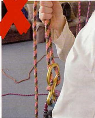
c) Gefahr, dass das Lastseil bei einer ruckartigen und starken Belastung (insbesondere bei Sturz mit Schlappseil) stark beschleunigt wird. Aufgrund der entstehenden Hitze, des Schmerzes und des Erschreckens kann es passieren, dass der Sichernde das Seil loslässt und der Kletternde abstürzt (**Absturzgefahr!**). Er selbst kann Verbrennungen an der Handinnenfläche davontragen.
